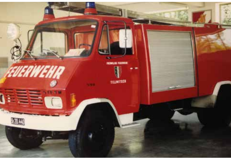
Funkrufname „TANK TILLMITSCH“ knapp 30 Jahre war das TLF 2000 (Tanklöschfahrzeug 2000 Liter Wassertank) im Einsatz.
